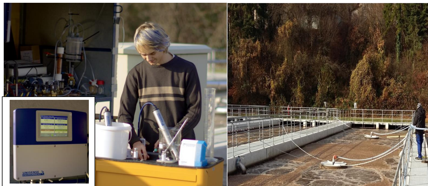
Abb. 2: Kalibrieren des Sensors durch Herrn Stefan Kühling (Gerätewart auf der Kläranlage Pforzheim)
