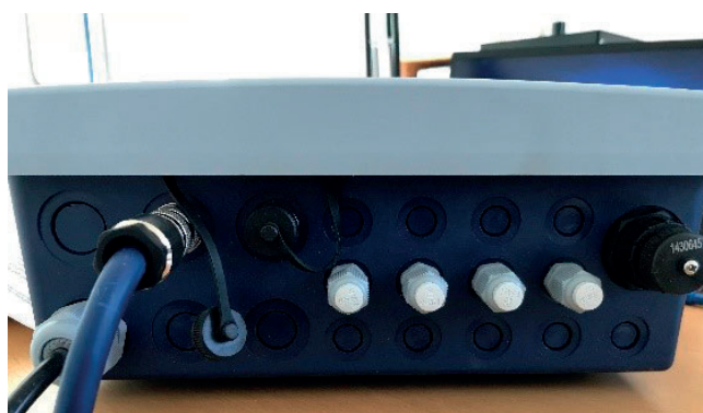
Placeringen af strømforsyningen og tilslutning til N 2 O Wastewater Sensor 1
