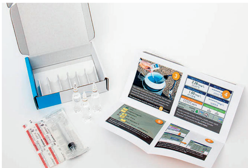
N 2 O Kalibreringskit, som bruges til en 2-punkts kalibrering af N 2 O Wastewater sensoren
