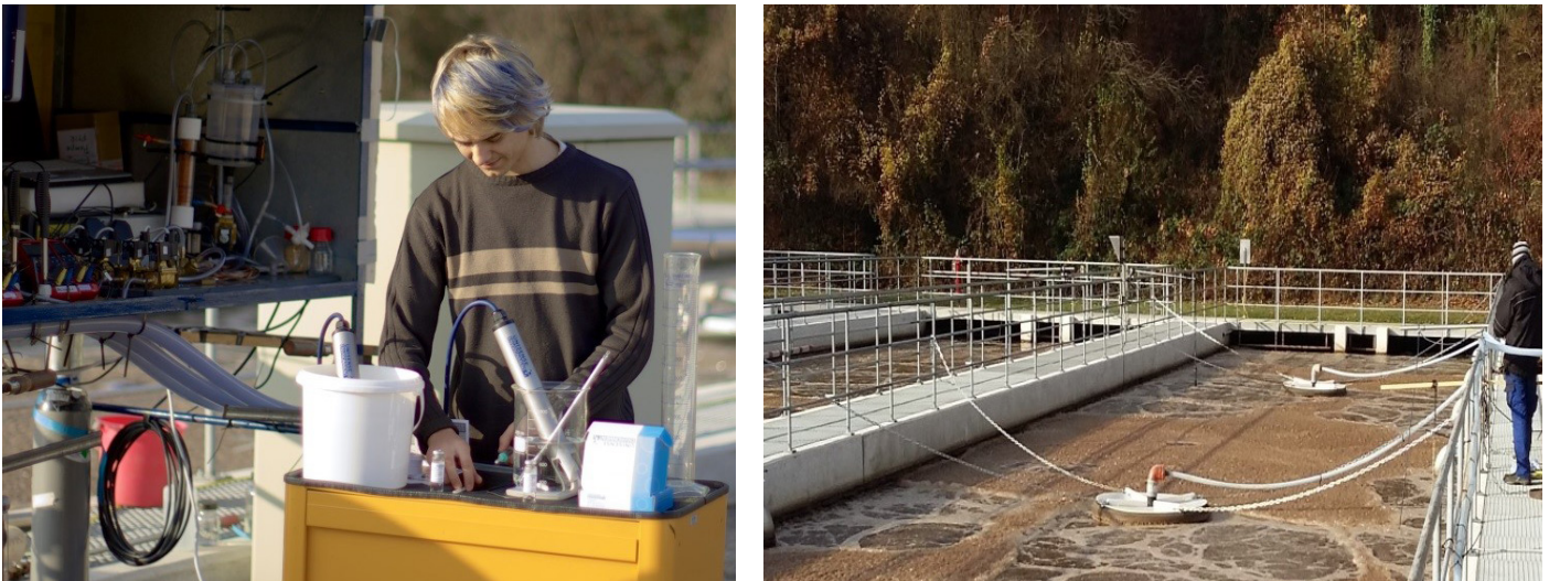
Abb. 2: Kalibrieren des Sensors durch Herrn Stefan Kühling (Gerätewart auf der Kläranlage Pforzheim)
